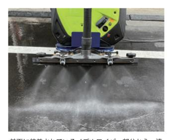
前面に装着されているノズルワイパー部分から、清水を噴射させることができます。これにより、固まりやすい汚泥を液状にし、水切りをしながら汚泥水を綺麗に吸引することができます。
