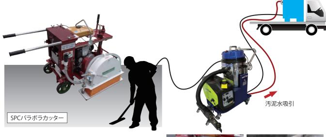
湿式パラボラカッター作業時に発生する汚泥水 (右写真参照)を、クリーナーでブーストタンク に吸引し、タンクへ回収します。また、乾式の場 合はブーストタンクのみで吸引回収ができます。
