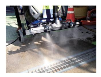
前面に装着されているノズルワイパー部分から、清水を噴射させることができます。これにより、固まりやすい汚泥を液状にし、水切りをしながら汚泥水を綺麗に吸引することができます。
