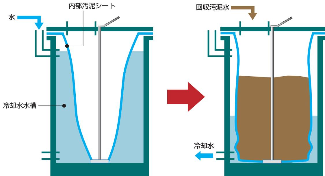
タンク内の特殊二重構造により、カッター作業で使用する冷却水が減った分、内部汚泥シートが膨張し、回収した汚泥水がシート内に貯留される仕組みになっております。完全に分離されているので、カッター冷却水と汚泥水が混合することはありません。
