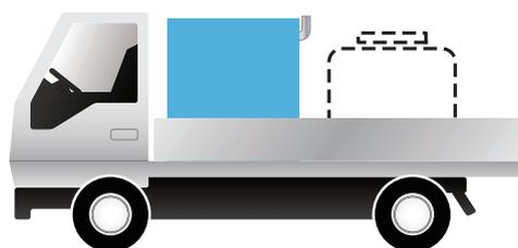
従来の舗装版切断作業の場合、冷却水タンクと汚泥水回収用タンクを装備する必要がありましたが、この「布袋くん」を利用することで、二つの処理を同時に行えるため、従来の冷却水タンクと同等の大きさで、省スペース化を実現しています。
